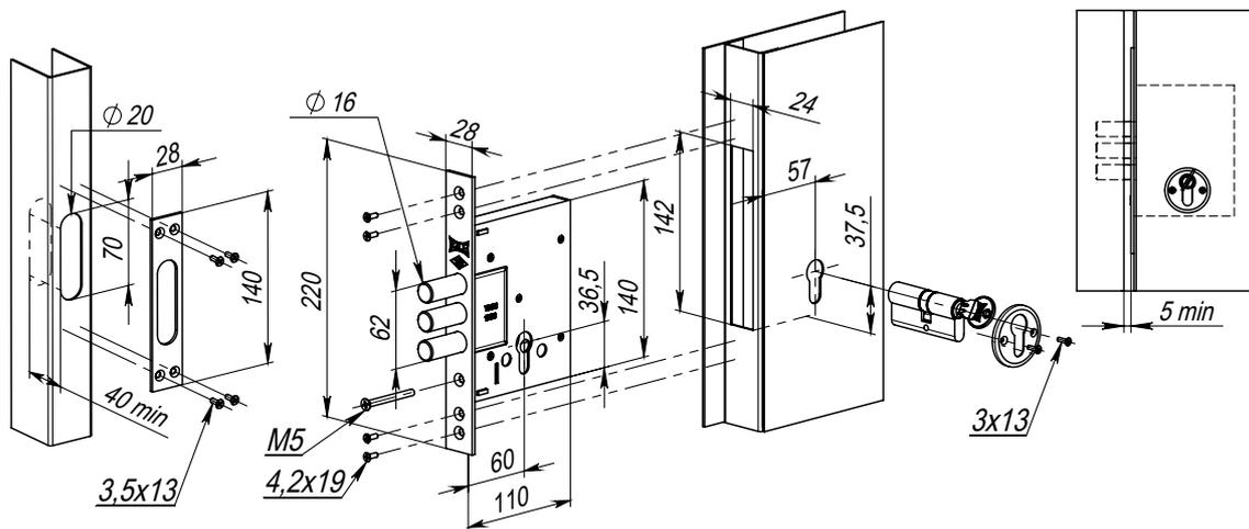
Порядок установки врезного замка KALE 257 (рис.1)
