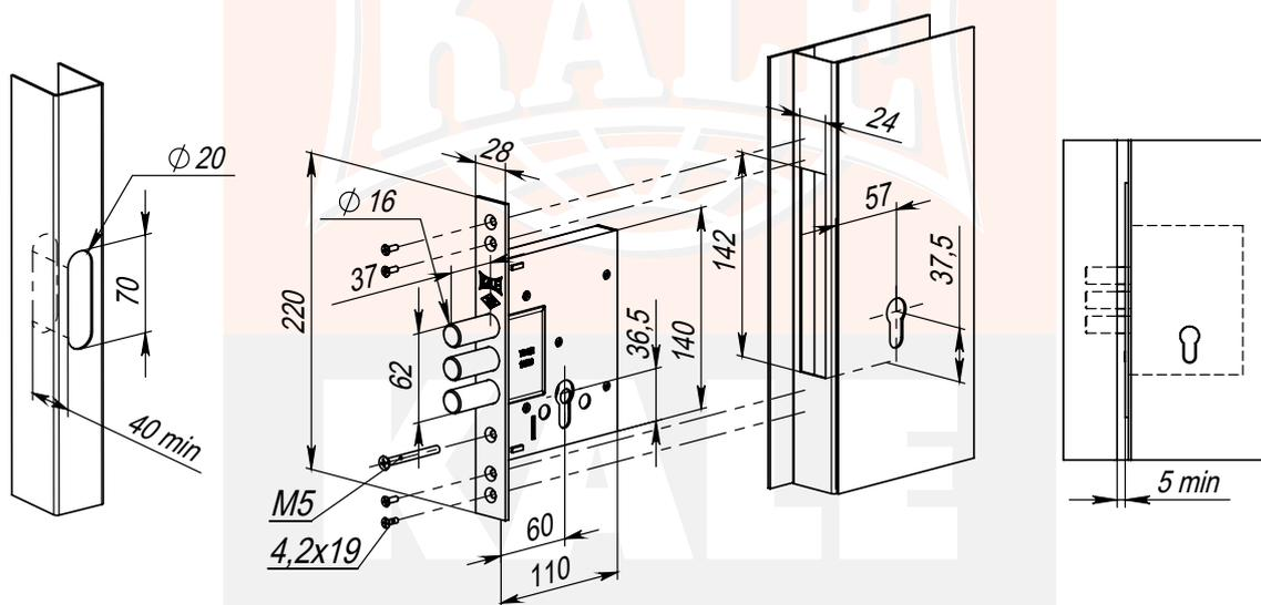
Порядок установки корпуса замка врезного KALE 257 (рис.2)
